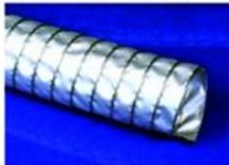
Tubazione realizzata con tessuto per alte temperature ricoperto di PU, rinforzato da una trama in acciaio inox. Spirale esterna in fili di acciaio zincato.
