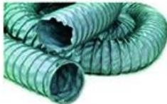
Tubo flessibile a doppio strato costituito da un tessuto per alte temperature spalmato di PU e rinforzato da una trama di acciaio inossidabile. La spirale esterna in acciaio zincato.
