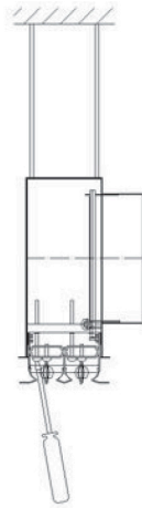
Fig. 2 Montaggio con viti laterali al plenum fissato al soffitto
