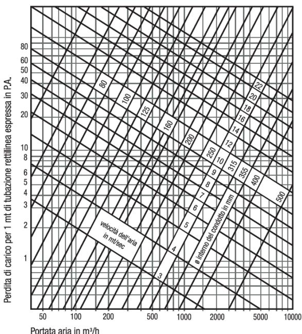
Esempi di calcolo delle portate e delle perdite di carico:
